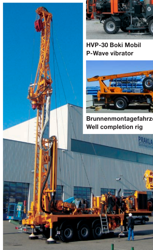
RB 50 auf Trailer, mit Mastverlängerung RB 50 on trailer, with mast extension
