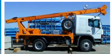
Brunnenmontagefahrzeug Well completion rig
